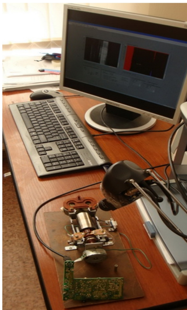
Рис.1 – Комплекс для диагностики подшипниковых узлов электрического подвижного состава
